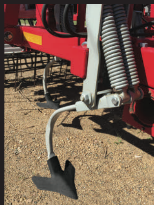
С-образная заостренная стойка с двумя пружинами (усилие на отведение 136 кг)
